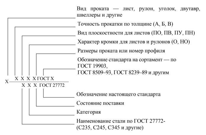
Прокат горячекатаный листовой повышенной точности (A), высокой плоскостности (ПВ), с обрезной кромкой (O), размерами ( $10 \times 1000 \times 2000$ ) мм по ГОСТ 19903, из стали С390, в улучшенном состоянии (У), категории 6:
